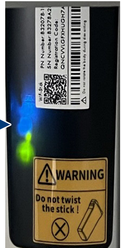
Abb. 13. Verbindung hergestellt – blaue LED blinkt.
