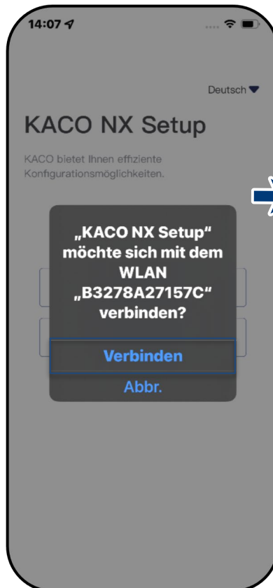
Abb. 8. Zugang mit mobilem Endgerät auf die Kommunikationseinheit
