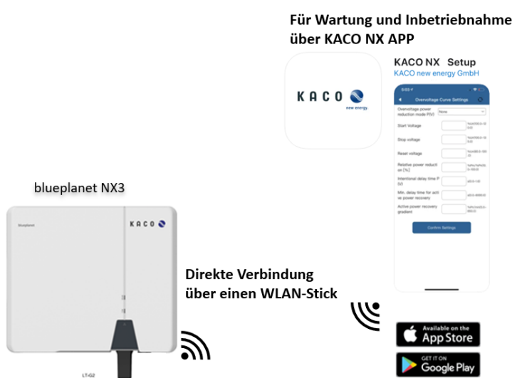
Abb. 1. Zugriff über APP auf ein Gerät mit eingesteckter Kommunikationseinheit (schwarzer WiFi Stick)
