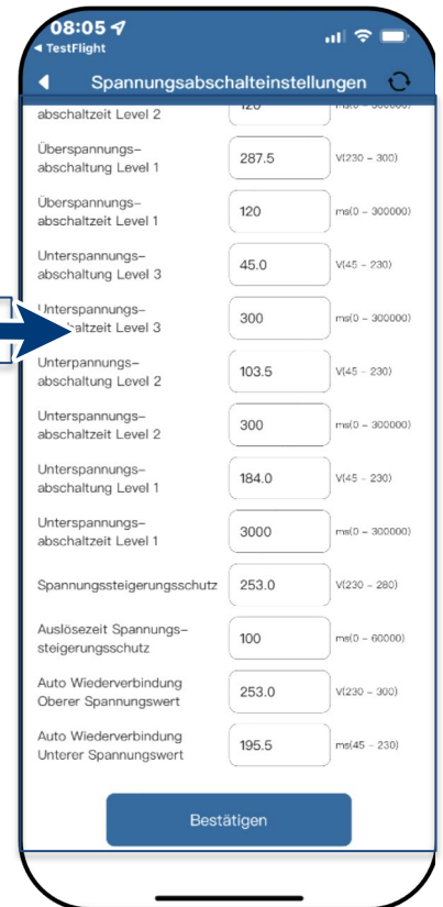
Abb. 60. Spannungsbereich und Abschaltzeiten definieren
